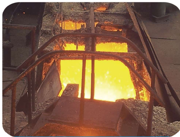
高炉冲渣过程
